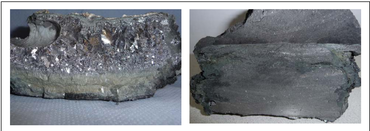
Bild 8: Darstellung der Reaktionsprodukte: Metallphase aus Versuch 3 (links) und metallische Fläche des durchgesägten Blocks von Versuch 2.2 (rechts) [23]
